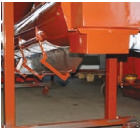
Пристрій вторинного змішування (легко проводити очистку)
