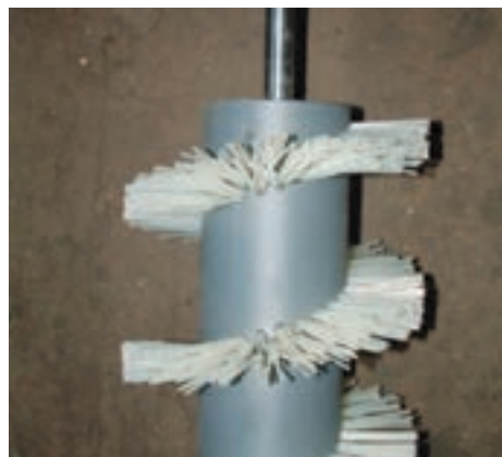
Щітковий шнек (зі спеціального нейлонового ворсу не пошкоджує насіння)
