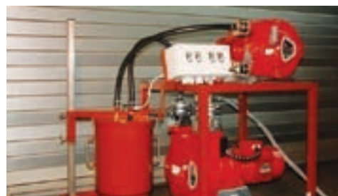
Станція насоса-дозатора з помпою наповнення
