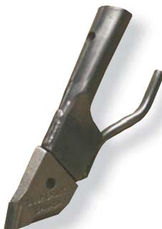
На данные держатели сошника для внесения NH3 удобрений можно устанавливать любые из перечисленных на стр. 16-17 **сменных наконечники категории 1** (продаются отдельно), которые крепятся при помощи болта и гайки 200-BNC-3100. Трубка для NH3 удобрений имеет внешний диаметр 12 мм. Для предотвращения повреждений наконечника при установке сошника на адаптер, необходимо использовать спец. инструмент.
