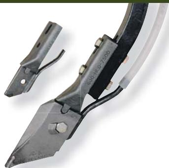
Данный держатель сошника болтового крепления для внесения NH<sub>3</sub> удобрений может оснащаться хромовым 600-TIP-7500 или карбидным 600-TIP-7501 19 мм наральником, устанавливаемым при помощи болта и гайки 600-BNC-5000. Наружный диаметр трубки для внесения NH<sub>3</sub> удобрений в жидком виде составляет 12 мм.
