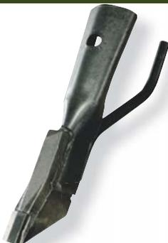
Сошник 200-KNF-7525 оснащен 19 мм приваренным карбидным наральником. Трубка данного сошника длиннее и отогнута на большее, по сравнению с трубкой сошника 200-KNF-752, расстояние, что позволяет использовать данный сошник на пневматических сеялках, семявыводы которых расположены позади стоек. Наружный диаметр трубки для внесения аммиака в жидком виде составляет 12 мм.
