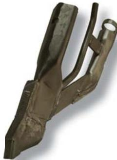
Данный сошник оснащен 19 мм карбидным наральником, 12 мм трубкой для внесения NH<sub>3</sub>, а также трубкой большего диаметра для гранулированных удобрений. Каталожный номер сменного наральника: 410-TIP-0801. Инструкции по замене и привариванию наральников смотрите на стр. 94. Для предотвращения повреждений наконечника при установке сошника на адаптер, необходимо использовать спец. инструмент (400-DRV-1010). NH<sub>3</sub> и сухие удобрения укладываются в один ряд.
