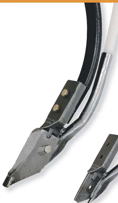
**Подача семян** – Семена подаются через семявыводы с наружным диаметром 31 или 28 мм. Семяпровод диаметром 28 мм требует дополнительного использования втулки 880-BSH-1130. Данный сошник лучше всего подходит для установки на стойки Bourgault.
