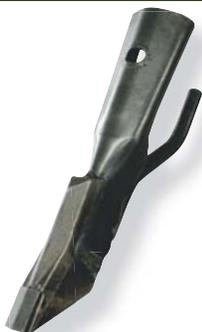
Для увеличения срока службы данный сошник 200-KNF-7521 оснащается 19 мм наральником с карбидной наплавкой. Карбидная наплавка позволяет также сохранять наконечник острым, что улучшает качество его проникновения в почву даже на твердых и плотных почвах. Трубка для NH3 удобрений имеет внешний диаметр 12 мм. Данный сошник можно также приобрести с обычным хромовым наральником (200-KNF-7520). Сменные привариваемые наральники: хромовый 100-TIP-7500 и карбидный 200-TIP-7501.
