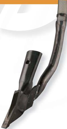
**Подача семян** – подача семян осуществляется сзади через круглый семявывод, отведенный назад во избежание забивания при работе в условиях глинистых почв. Данный семявывод используется с семяпроводом с наружным диаметром 31 и 28 мм. Семяпровод диаметром 28 мм требует дополнительного использования втулки 880-BSH-1130.
