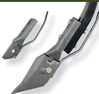
Данный держатель сошника болтового крепления для внесения NH<sub>3</sub> удобрений может оснащаться хромовым 600-TIP-7500 или карбидным 600-TIP-7501 19 мм наральником, устанавливаемым при помощи болта и гайки 600-BNC-5000. Наружный диаметр трубки для внесения NH<sub>3</sub> удобрений в газообразном виде составляет 9 мм.
