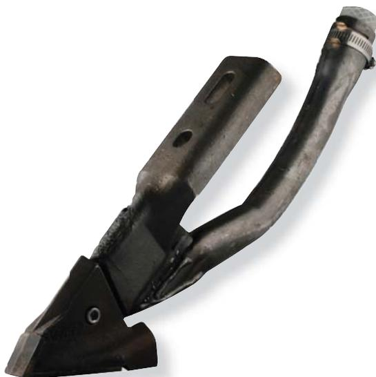
**Подача семян** – Подача семян осуществляется сзади через круглый семявывод, используемый с семяпроводом с наружным диаметром 31 и 28 мм. Семяпровод диаметром 28 мм требует дополнительного использования втулки 880-BSH-1130.
