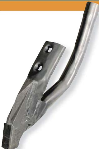
**Подача семян** – Семявывод для данного сошника совместим с семяпроводами с наружным диаметром 31 и 28 мм. Семяпровод диаметром 28 мм требует дополнительного использования втулки 880-BSH-1130.
