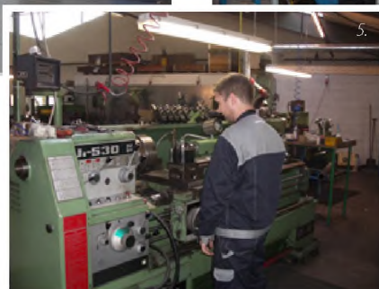
1. Проектирование с помощью 3-мерных графических редакторов. 2+3. Обработка листового металла на самом современном оборудовании для штамповки и лазерной резки. Благодаря этому сокращается время выполнения производственных операций и сроки поставок. 4. Работа сварочных автоматов. 5. Изготовление втулок и валов в механическом цехе.
